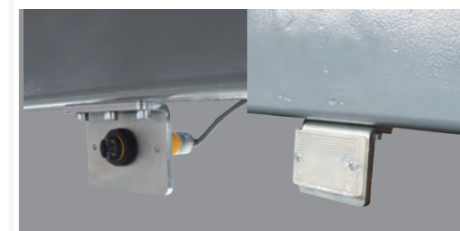
红外同步保护装置, 防止车辆侧翻
