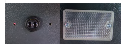
红外同步保护装置，预防平台不同步运行导致事故
