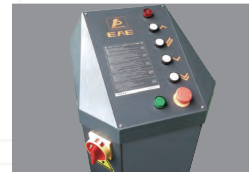
低压 (24V) 控制系统, 急停按钮
