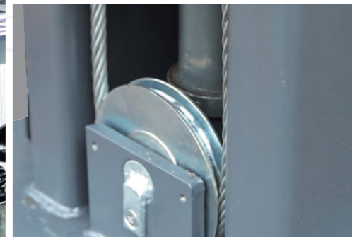
滑轮脱轨保护装置
