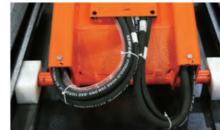
耐磨滑块，配拆装式滑块压板，更换方便
