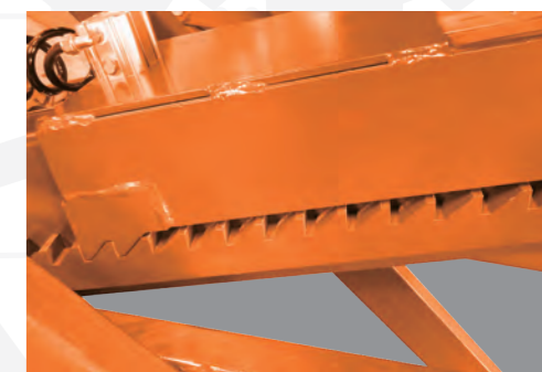
机械锁和气动解锁装置
