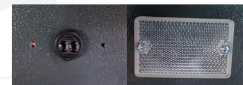
红外同步保护装置, 预防平台不同步运行导致的事故
